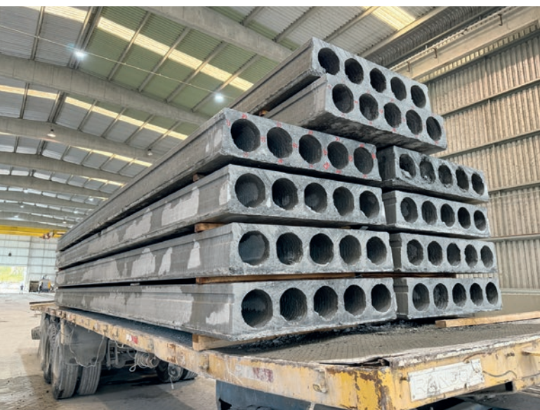
Placas alveolares pretensadas de 5 alveolos, fabricadas con la extrusora EVO2 de Nordimpianti
