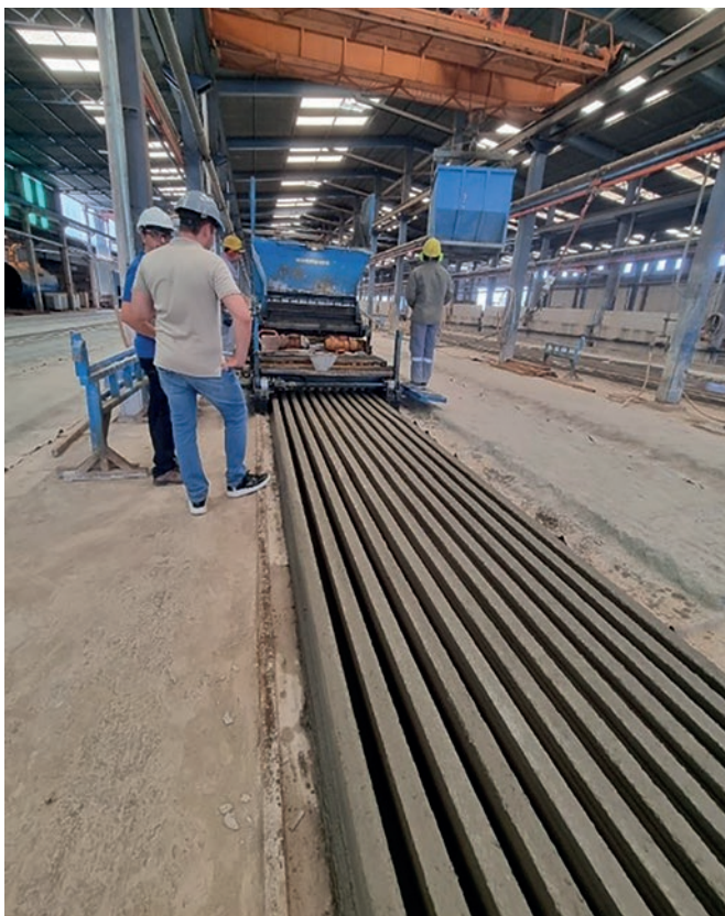
Hormigonado de vigas I de 210 mm de grosor con la máquina deslizante de Nordimpianti
