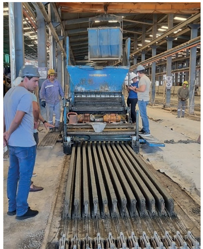
Hormigonado de vigas I de 210 mm de grosor con la máquina deslizante de Nordimpianti
